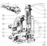
Fig. 7. Unloader valve.
