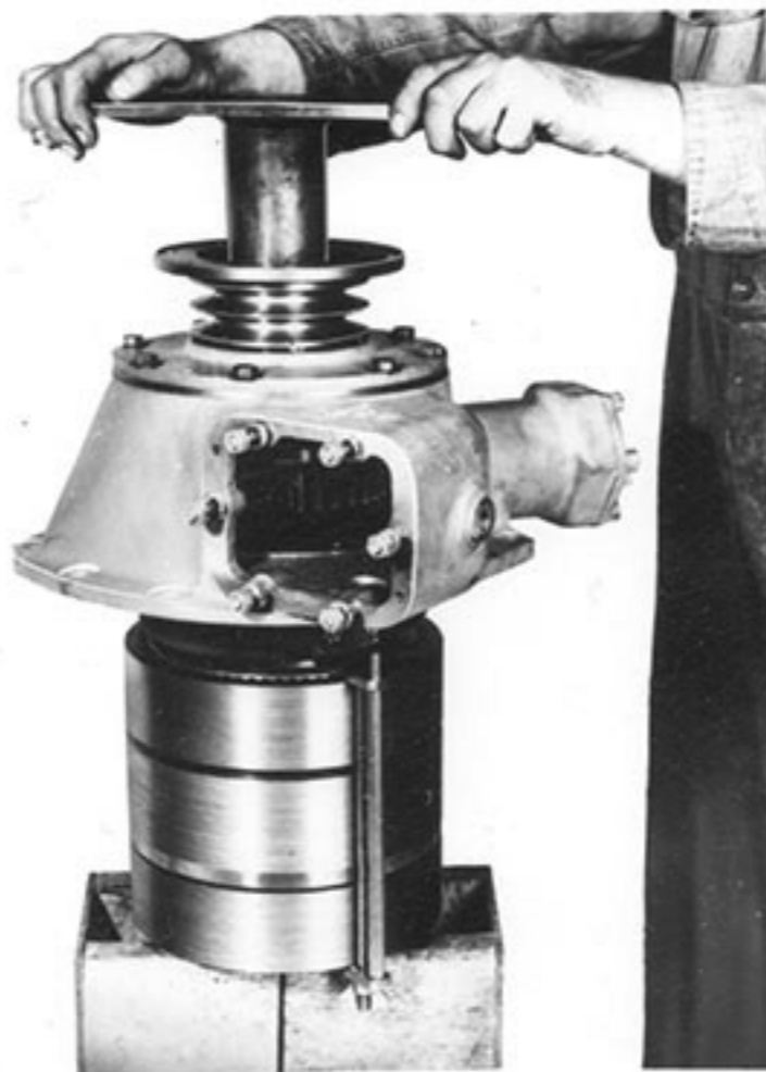
26. TIGHTEN THE INPUT END NUT.
